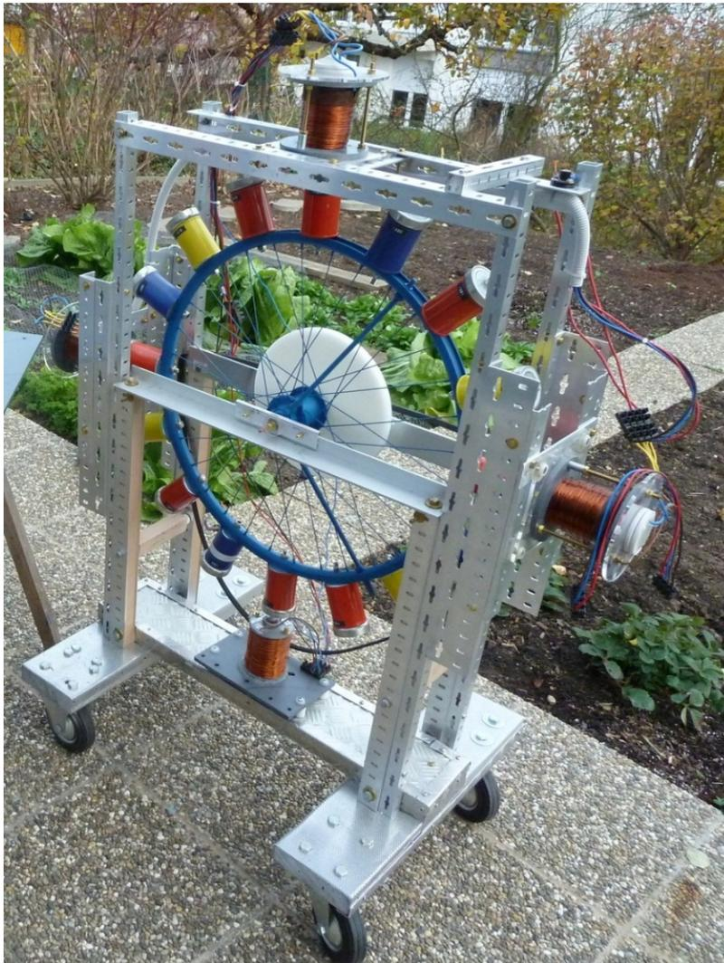
Abb.14: Photo eines Bedini-Generator-Nachbaus.
