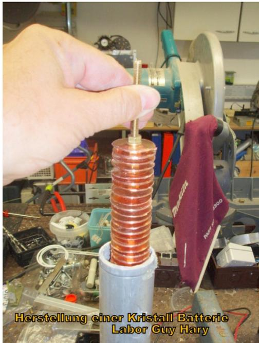
Abb.13: Kristallzelle beim Aufbau im Labor eines Luxemburger Experimentators [Har 12].
